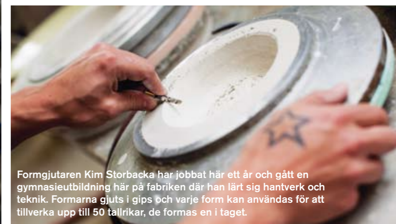
De nyformade tallrikarna får stå och torka. I denna fas är de mycket sköra och har vassa kanter. Dem putsar Aili Huhtala med van och säker hand. Hon har arbetat här i elva år och trivs bra.
